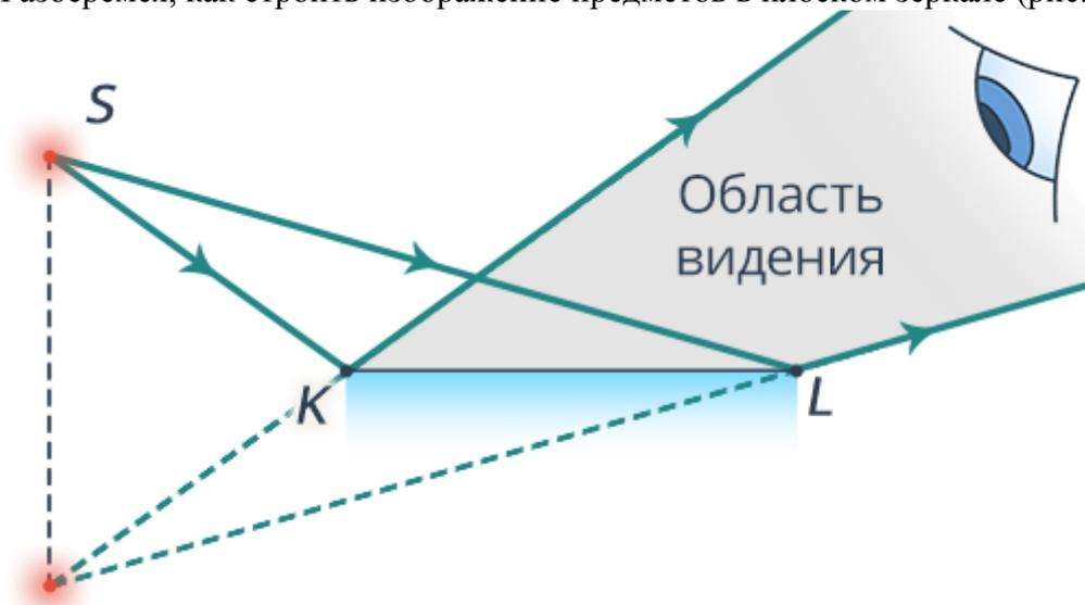
Рис. 8. Построение изображения предмета в плоском зеркале
